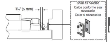
16 Install Support Screw Instale el tornillo de soporte Installer les vis de support 299 299-F OR 0 OU Metal Métal Metal #25 #10-24 mummOR O OU
